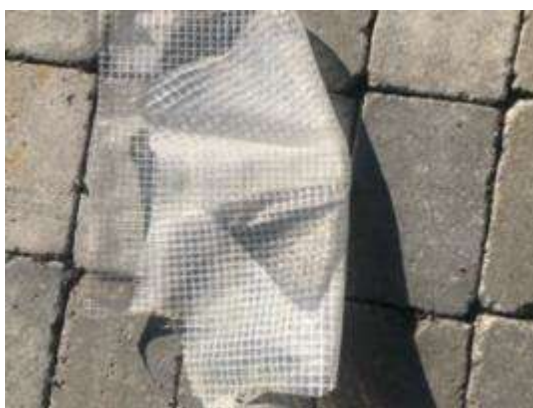
Väderskydd för ställning (vinterväv/ ställningsduk)
